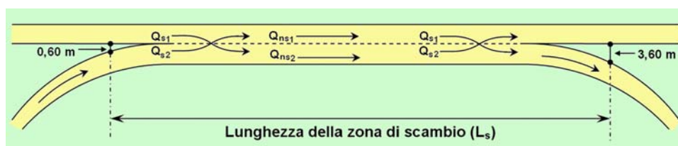
Figura 2. Zona di scambio a due corsie e portate veicolari di riferimento.
