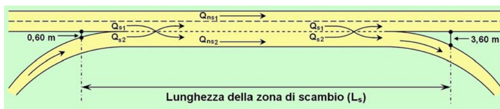
Figura 1. Schema di zona di scambio e portate veicolari di riferimento.
