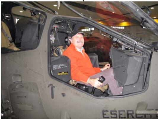
di volo e come si muove la mitragliera posta sul "naso" dell'elicottero, asservita allo stesso movimento del casco del cannoniere, che in questo modo mira e colpisce semplicemente muovendo la testa. Con semplicità e chiarezza ci sono stati illustrati gli apparati dell'avanzatissima avionica che equipaggia il Mangusta dandoci la possibilità di porre domande e curiosità, alle quali i tecnici presenti
